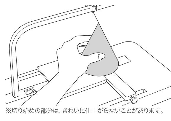
※発泡倍率によって熱切断の状態が異なりますので、端材でテストすることをおすすめします。
