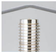
塩ビパイプの曲げ加工
