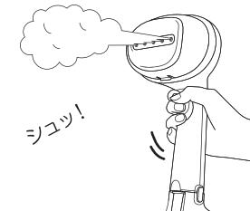
スチーマーを保管する際は、タンクの水を捨て、再度通電して残ったスチームを出し切ってください。カビ防止になります。
