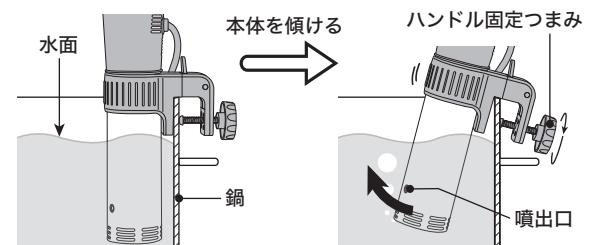
ハンドル固定つまみを緩め、図のように噴出口が上になるように本体を傾けるとポンプ内の空気が抜けます。
